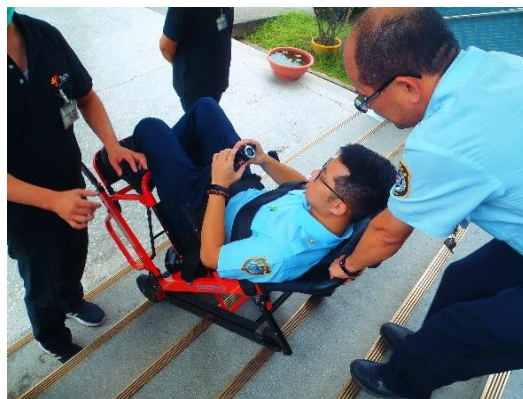
圖 29 折疊式電動爬梯機測試情形
