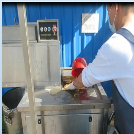
將熟廚放入處理槽
