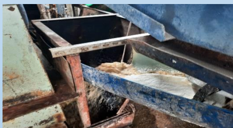
將廚餘卸入蒸煮槽
