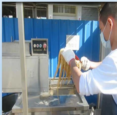
將熟廚放入處理槽
